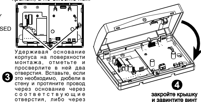
Рис. 2 - Монтаж блока управления
