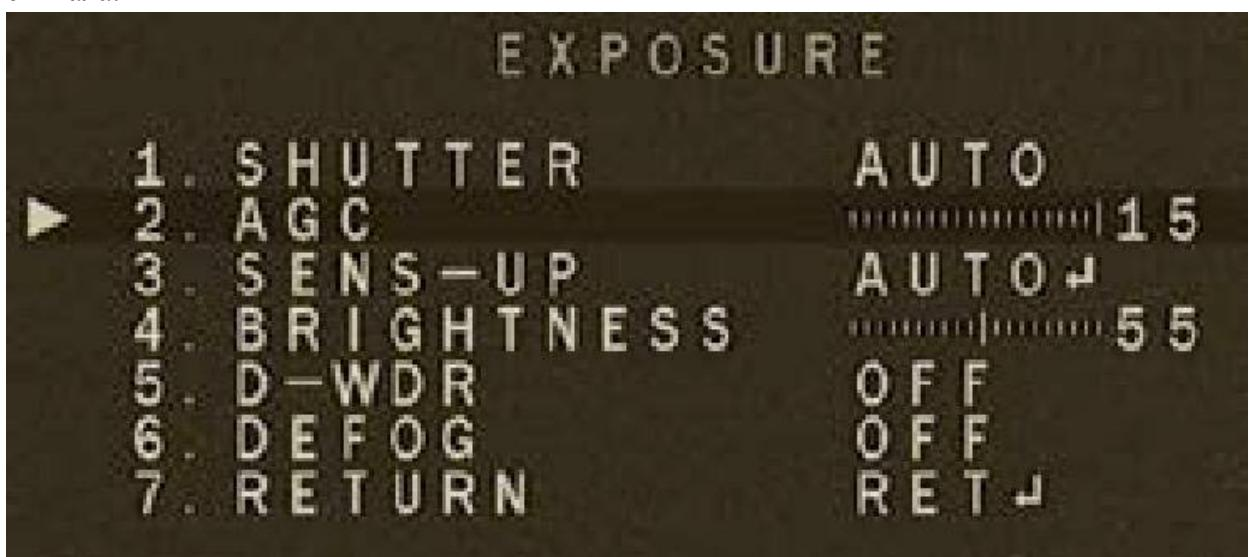
**5.2.1 Shutter (затвор)** – задает поведение сенсора и определяет как часто происходит снятие зарядов со светочувствительных элементов матрицы за один кадр.
