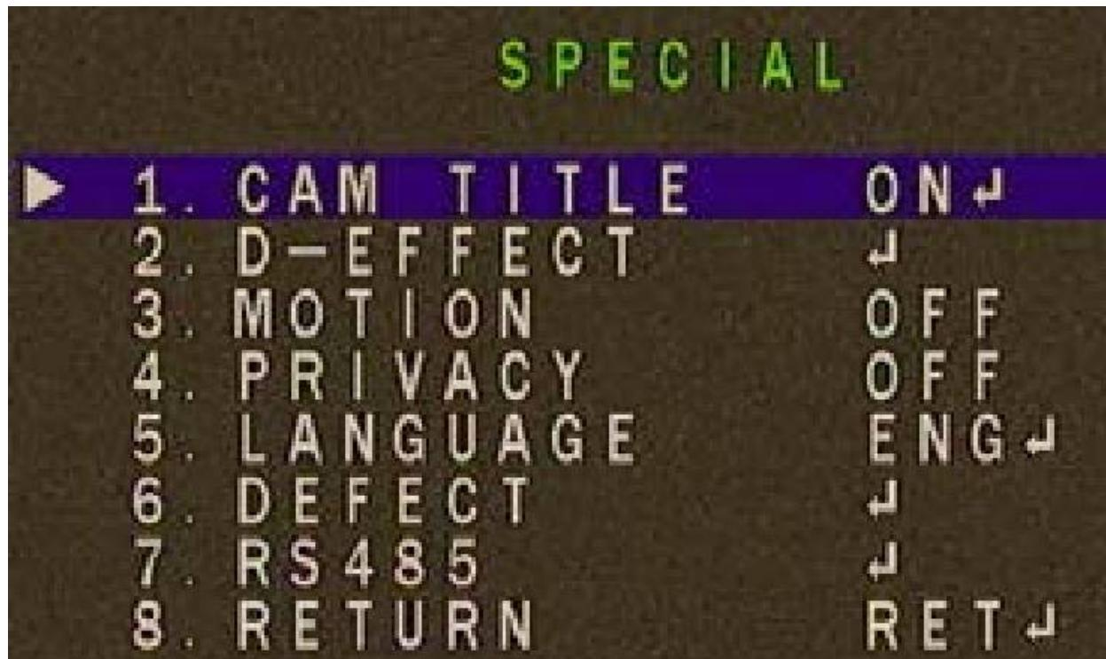
**5.7.1 Cam title (название видеокамеры)** – позволяет задать название видеокамеры и его положение на экране монитора.
